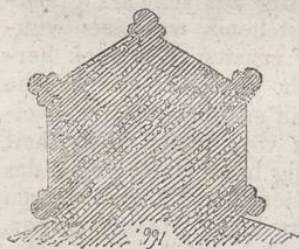
Marienkirche zu Stargard. Profil der Strebepfeiler der achteckigen Kapelle auf der Nordseite des Chores. (F. K.)
