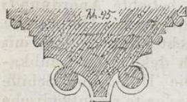
Quergurtprofil im Schiffgewölbe von St. Maria auf dem Kapitol zu Köln. (F. K.)
