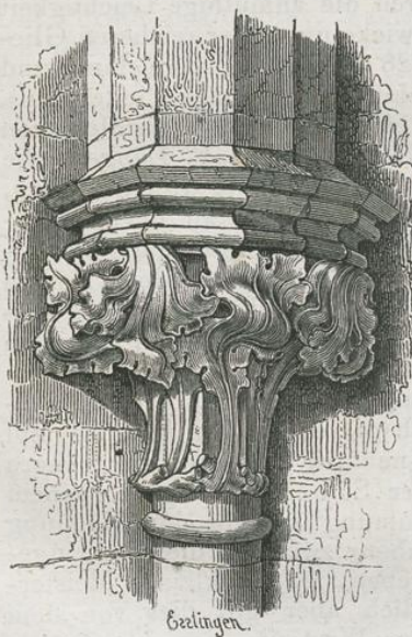
Frauenkirche zu Esslingen. Kapitäl im Innern des achteckigen Thurmgewölbes. (Nach Beis-barth, Kunst des Mittelalters in Schwaben.)
