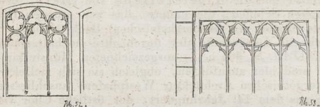
Arkadenmaasswerk der Kreuzgänge neben der Minoritenkirche und neben St. Severin zu Köln. (F. K.)
