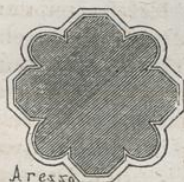
Arezzo. Im Dom von Arezzo. Profil der Schiffpfeiler. (Nach Wiebeking.)
