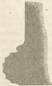
Profil der Säulenbasis beim Grabmal des Cyrus.
